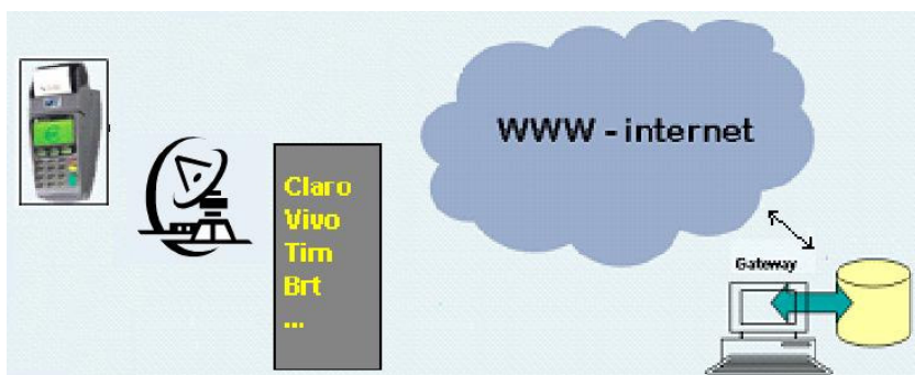
Figura 1.5 – Modelo de comunicação com POS GPRS
