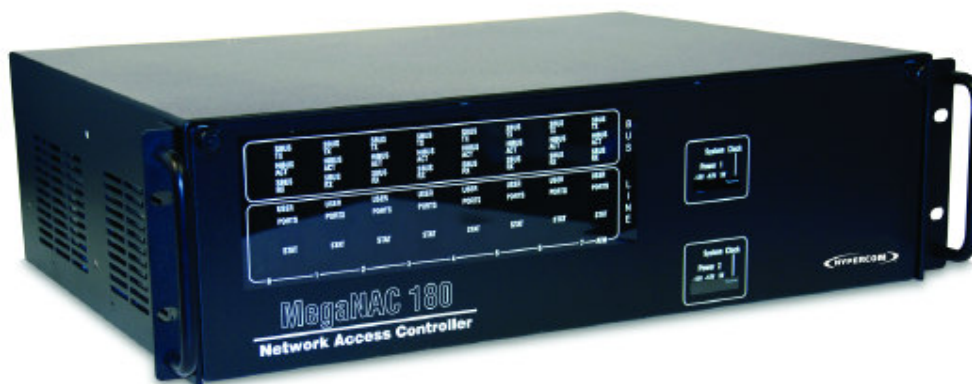
Figura 2.1 – Hypercom MegaNAC, concentrador de conexões de POS (SDLC).
