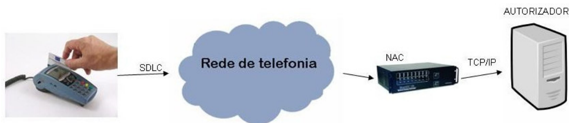
Figura 1.4 – Transação ocorrendo via modem discado
