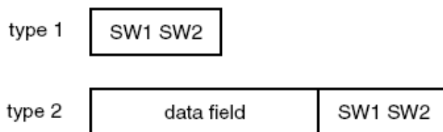
Figura 3.8 – Tipos de estrutura de um APDU de resposta. Fonte: RANKL e EFFING (2003, pág. 424).
