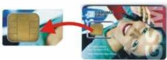
Figura 2.8 – SIM card GSM. Cartão no formato ID-1 com recorte no formato ID-000 Fonte: Schreiber, Souza, Garcia (2003).
