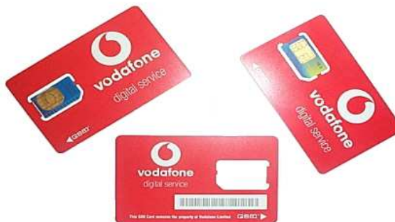
Figura 2.9 – Cartão com recorte ID-000 para destacar o SIM card. Fonte: http://www.m-99.co.uk/Mobile_Phone_SIM_Cards/Holder/holder.html
