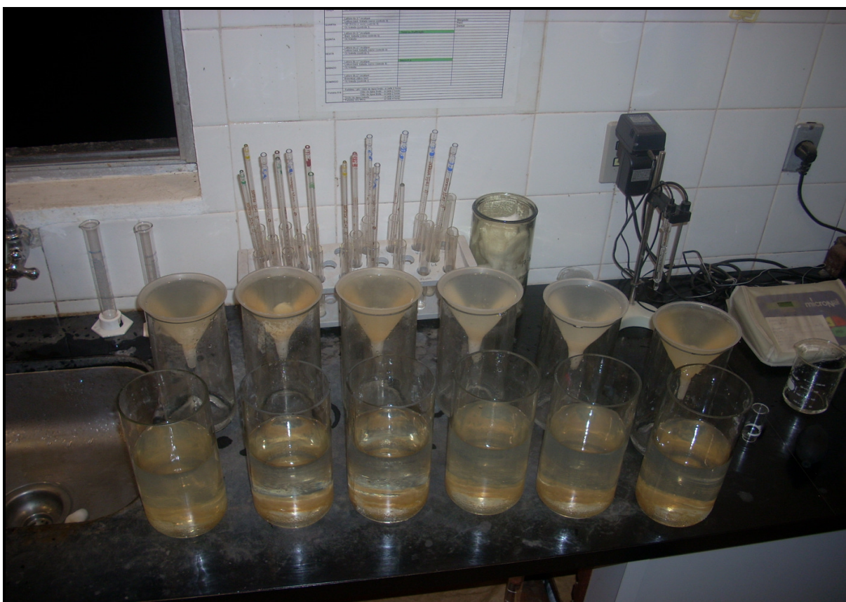
Figura 20 – Filtragem em laboratório com funil e algodão na ETA de CORSAN, Taquara, RS, 2009. Fonte – Elaborado pelo autor.
