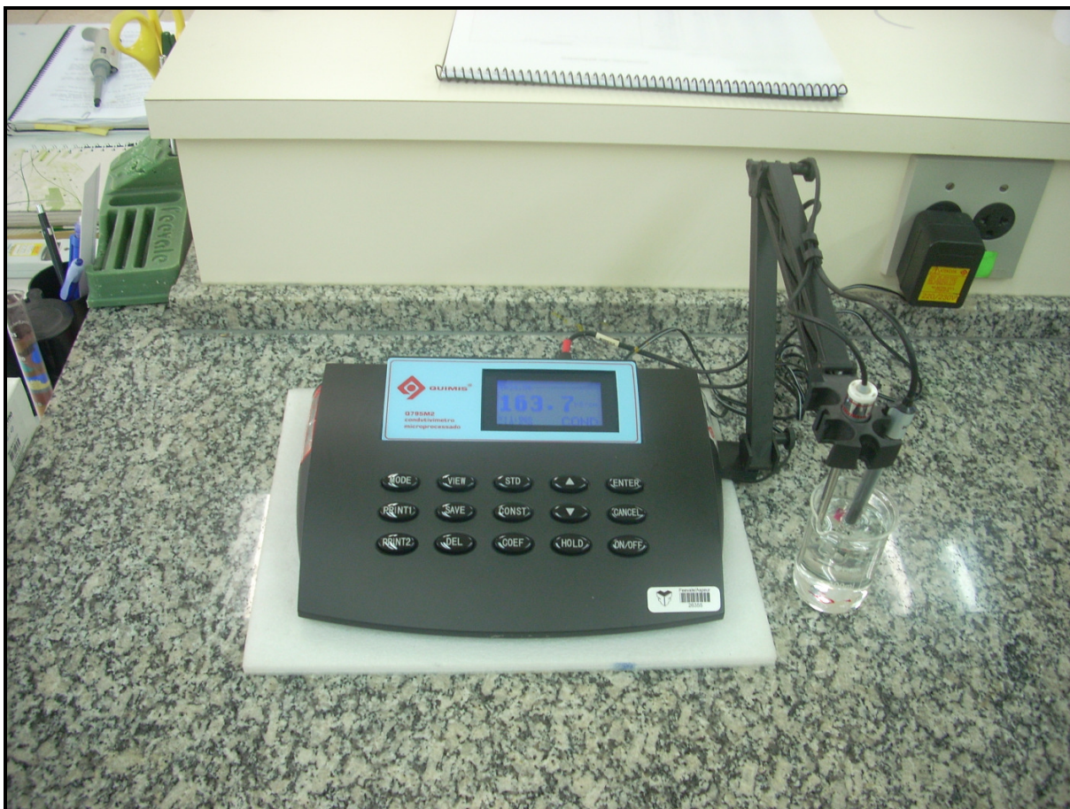
Figura 24 – Aparelho usado para medir a condutividade na Central Analítica da FEEVALE, NH, RS, 2009.
