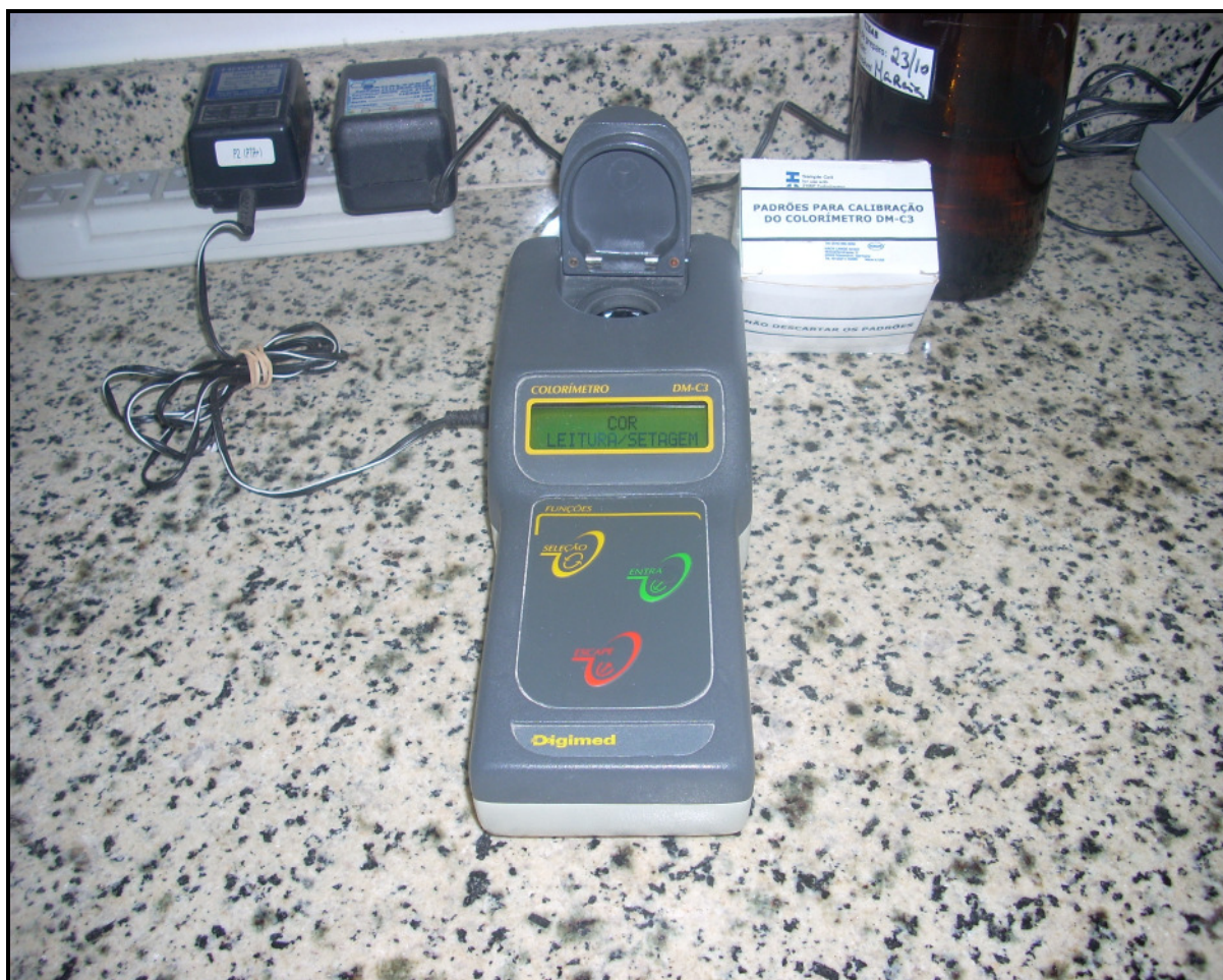
Figura 22 – Equipamento utilizado para medir cor no laboratório da ETA da COMUSA, NH, RS, 2009. Fonte – Elaborado pelo autor.
