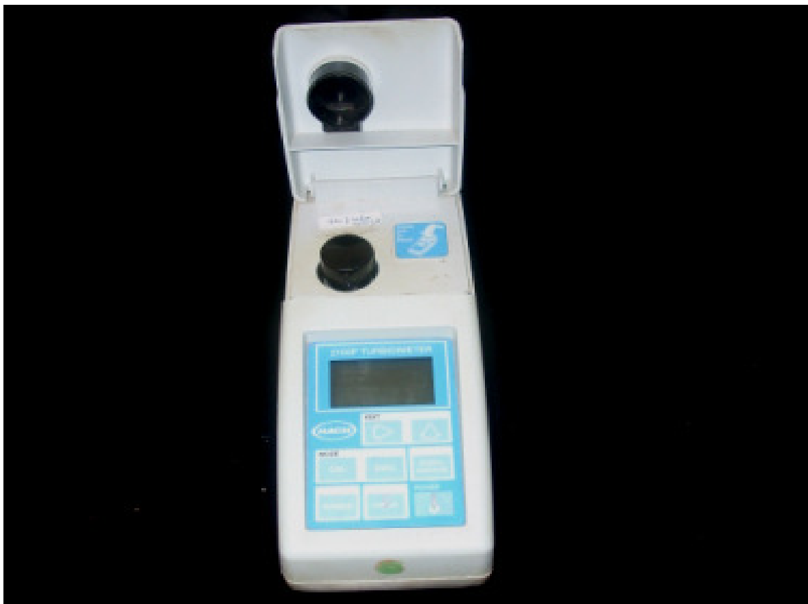
Figura 21 – Equipamento utilizado para medir turbidez no laboratório da ETA da CORSAN, Taquara, RS, 2009.
