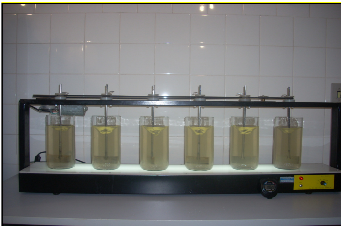
Figura 19 – Aparelho Jar-test no laboratório da ETA da CORSAN. Fonte – ETA CORSAN, Taquara-RS, 2009.
