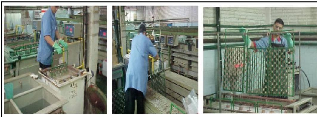
**Figura 14 - exemplo de operação manual de banho estático**
