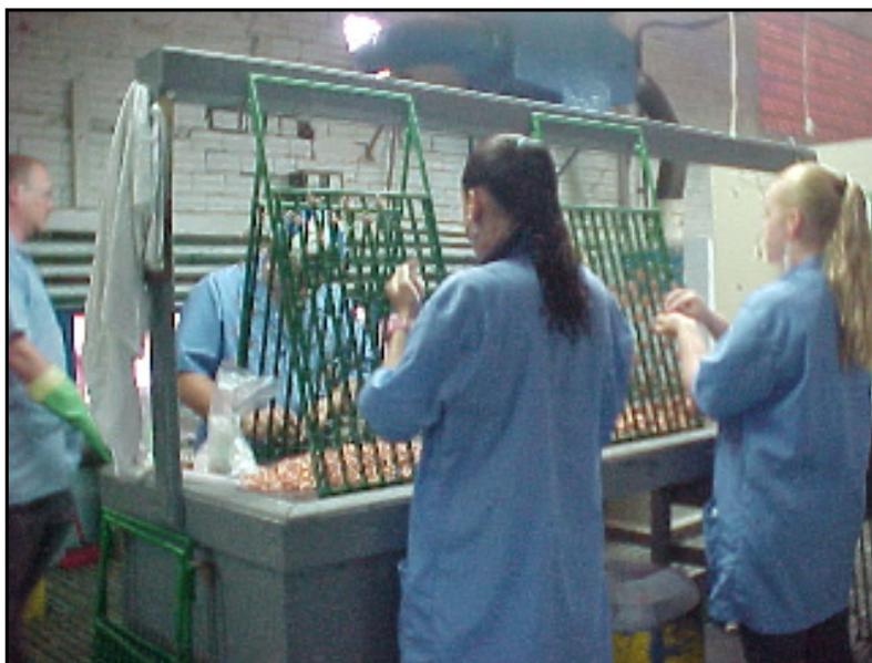
**Figura 13 - engancheamento de peças para banho
