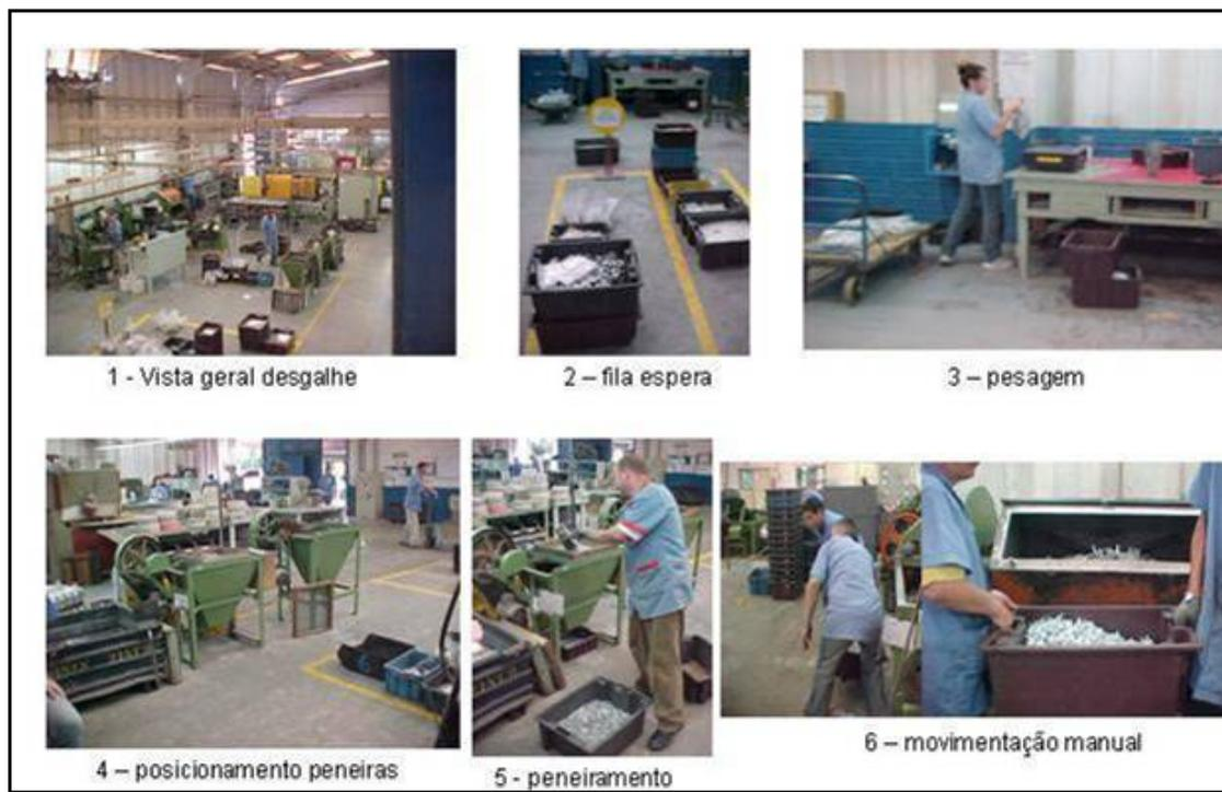
**Figura 20 - visão geral subprocesso Desgalhe**
