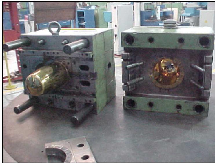
**Figura 11 - exemplo de molde de aço para injeção de zamac sob pressão**
