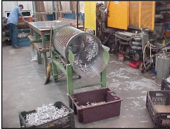
**Figura 24 - máquina separadora de rolos**
