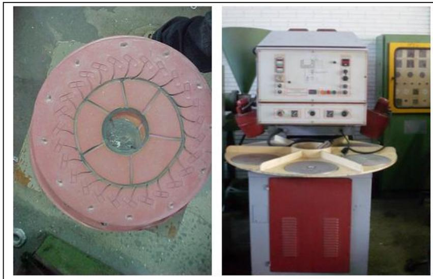
**Figura 12 – exemplo de molde de silicone e uma injetora centrífuga**
