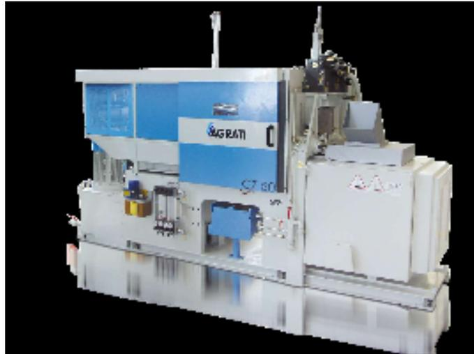
**Figura 10 - exemplo de injetora de zamac sob pressão.**
