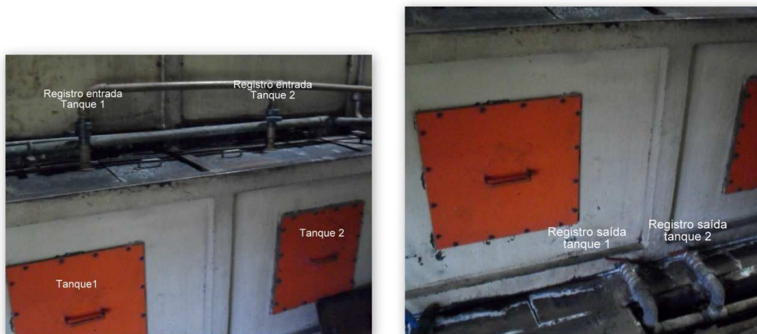
Figura 17 - Registros de entrada e saída das lavadoras Fonte: Dados fornecidos pela empresa
