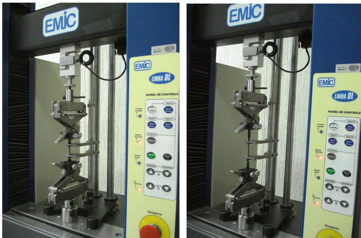
Figura 15: Fotos de um corpo-de-prova DIN S3A sendo tracionado em uma máquina Universal.
