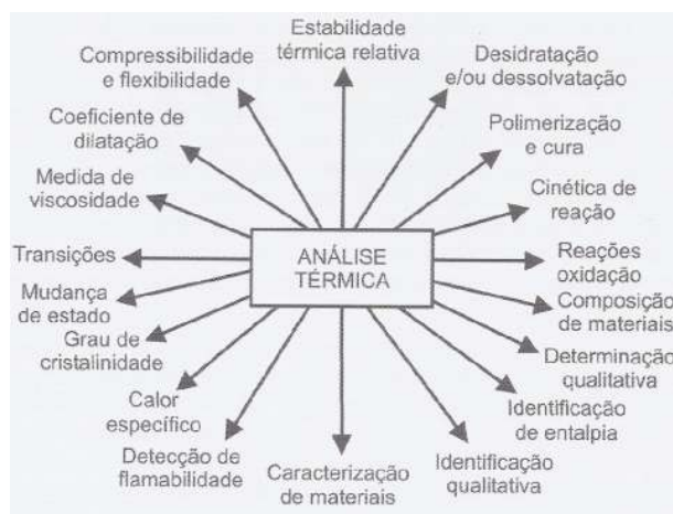
Figura 1.7 - Tipos de estudos que podem ser desenvolvidos com materiais poliméricos por análise térmica (13).
