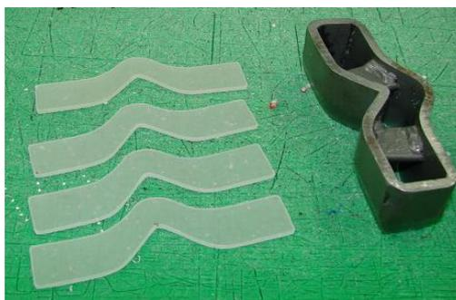
**Figura 9 - Formato de corpo de prova para ensaio de rasgamento.**
