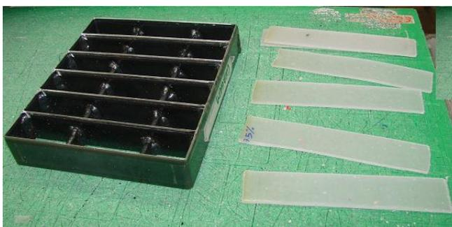
**Figura 10 - Formato de corpo de prova para ensaio de resistência à colagem.**
