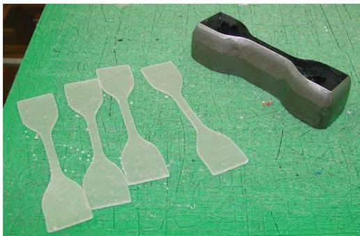
**Figura 8 - Formato do corpo de prova para ensaio de tração.**
