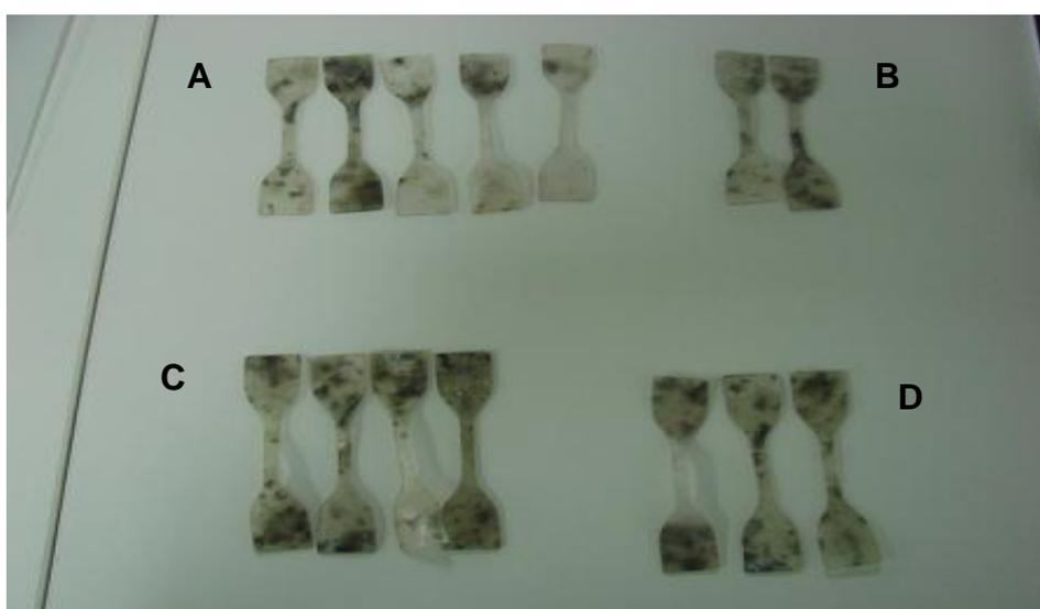
**Figura 23 - Corpos de prova enterrados no solo. A: PVC sem amido; B: PVC 5% amido; C: PVC 7,5% amido; D: PVC 10% amido.**
