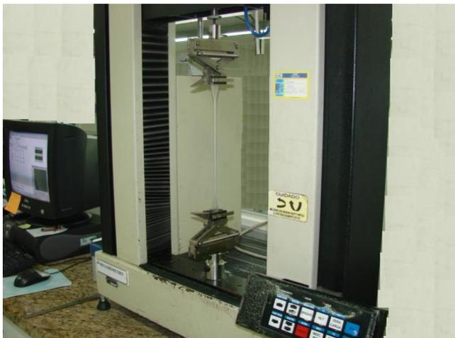
**Figura 11 - Dinamômetro em ensaio de tração**
