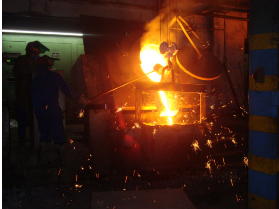
Figura 13 Liga metálica sendo despejada em cadinho Fonte: PROCESSO PRODUTIVO EMPRESA MODELO.
