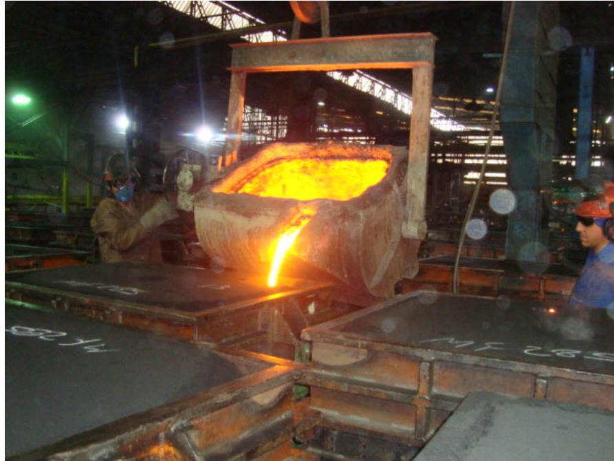
Figura 14: Vazamento da liga metálica para molde de areia Fonte: PROCESSO PRODUTIVO EMPRESA MODELO.
