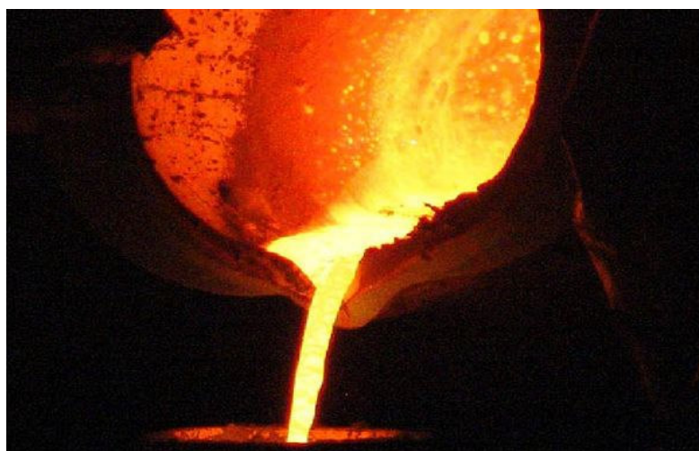
Figura 11: Processo de vazamento de ferro fundido para molde de areia Fonte: PROCESSO PRODUTIVO EMPRESA MODELO.
