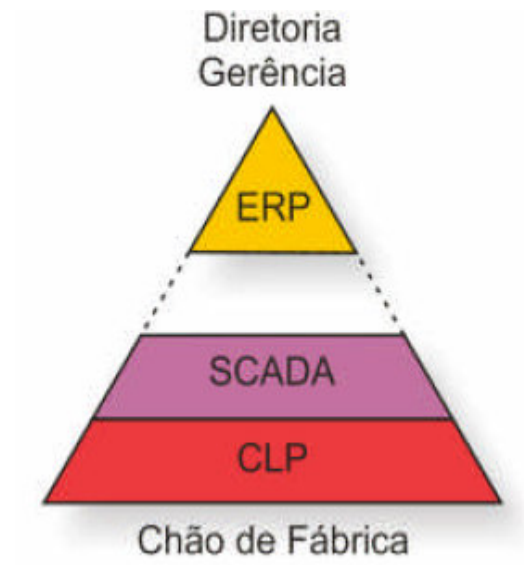
Figura 10: Pirâmide de automação. Sistema não integrado Fonte: FILHO (1998)
