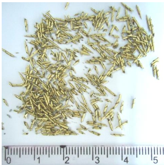
Figura 17 - Cavacos obtidos no processo de usinagem da liga C 360 Fonte: Elaborado pelo autor
