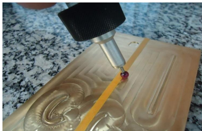
Figura 12 - Medição de empenamento Fonte: Elaborado pelo autor
