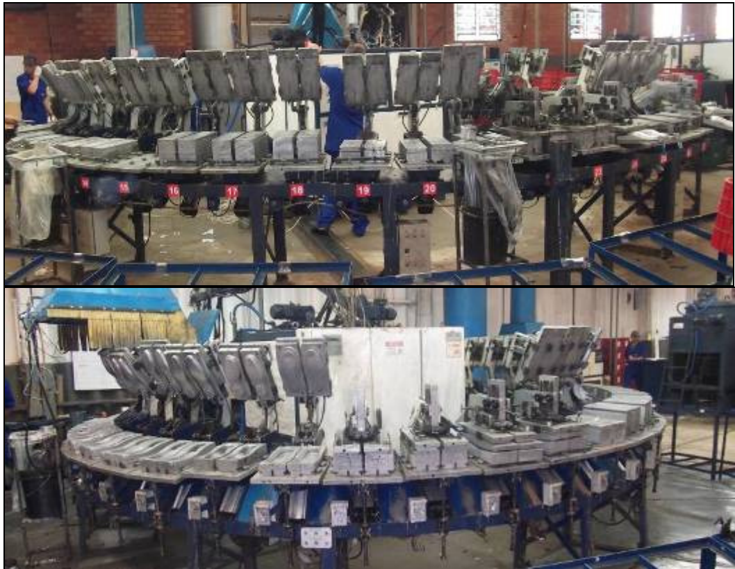
Figura 4 – Injetoras de solados de PU tipo carrossel.
