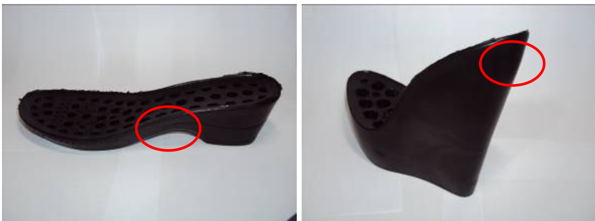
Figura 8 – Pontos de medida da dureza Shore A.
