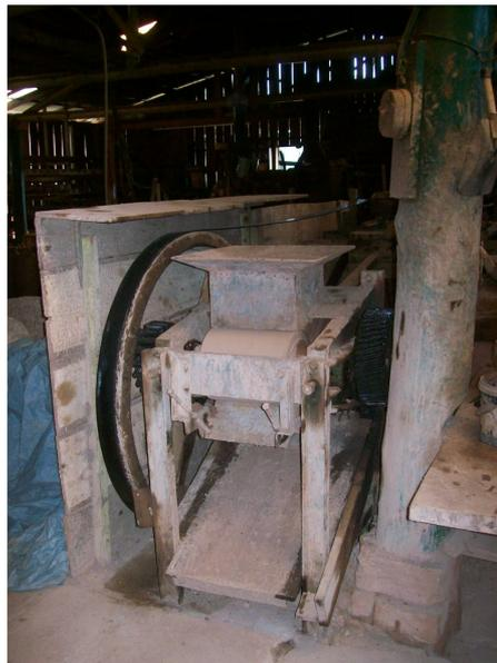
**Figura 9 – Maromba pequena: máquina de homogeneização e mistura fina da argila. Fonte: o autor**
