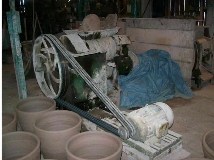
**Figura 8 – Maromba grande: máquina de homogeneização e quebra de pedras de argila. Fonte: o autor**
