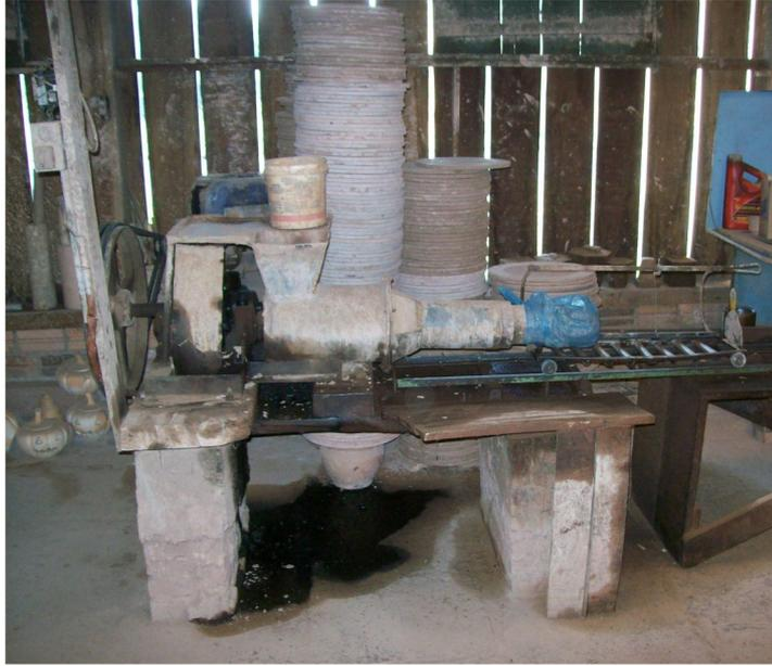
**Figura 10 – Cilindro de pesagem, onde é realizada a pesagem da massa de argila. Fonte: o autor**
