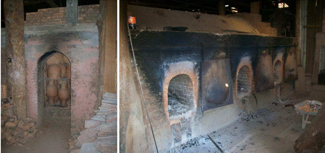
**Figura 12 – Forno onde é realizada a queima do coletor.
