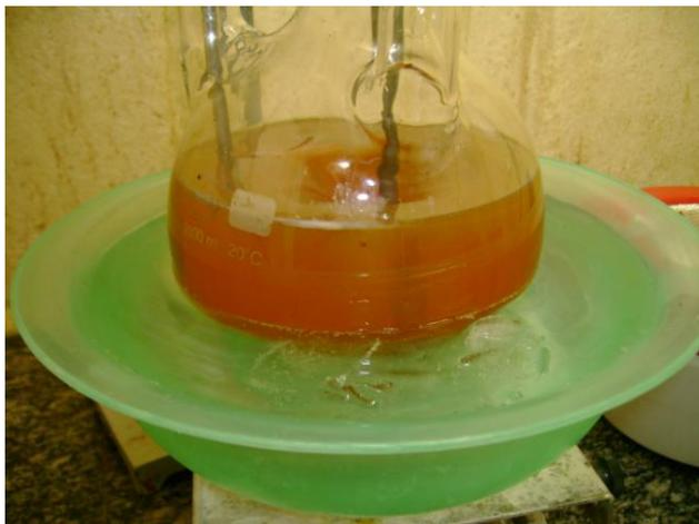
**Figura 34** – Resfriamento do óleo de soja sulfitado.
