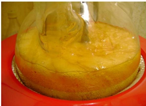
**Figura 31** – Reação de sulfitação do óleo de soja.
