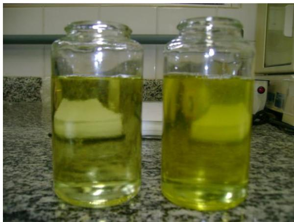
**Figura 27** - Óleo de soja refinado (esquerda) e oxidado (direita).
