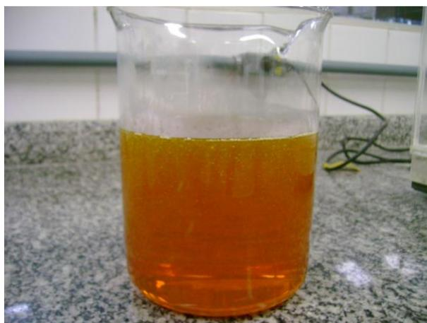
**Figura 35** – Óleo de soja sulfitado e pronto para aplicação em couro.
