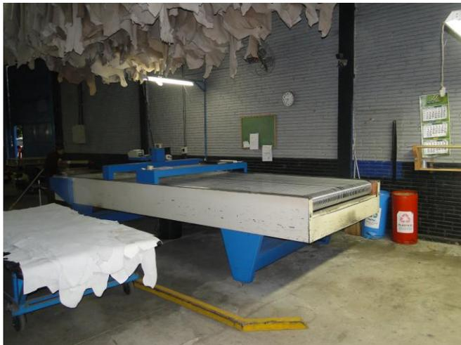
**Figura 28 - Equipamento de medição de couro (expedição)**
