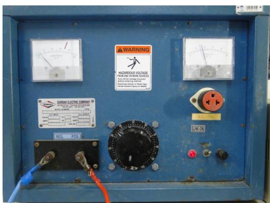
**Figura 21- Gerador de corrente elétrica**
