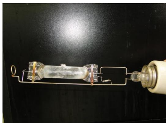
**Figura 22 - Lâmpada de vapor de mercúrio (400 W)**
