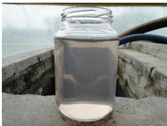
**Figura 13 - Efluente na saída do trat. primário**
