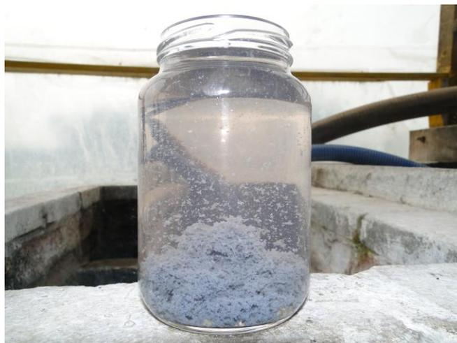
**Figura 11 – Visualização da sedimentação dos flocos**
