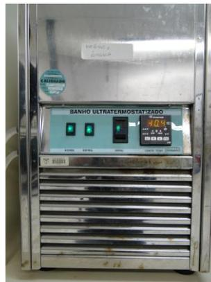
**Figura 24 – Banho ultratermostatizado (Marconi)**
