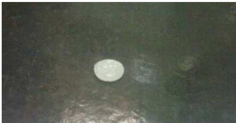
Figura 8: Scaffold em PU-1 após secagem. Fonte: DO AUTOR, 2012.
