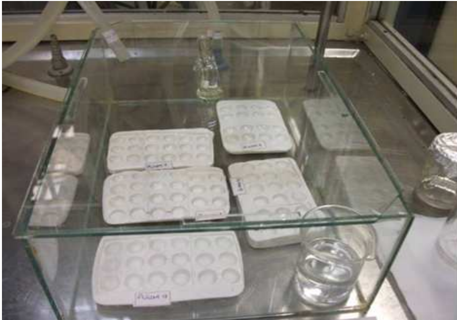
Figura 7: Políuretanos nas formas utilizadas para confecção dos scaffolds . Fonte: DO AUTOR, 2012.
