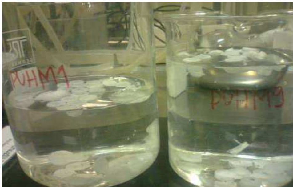
Figura 10: Scaffolds de PU-1 e PU-9 em água destilada. Fonte: DO AUTOR, 2012.
