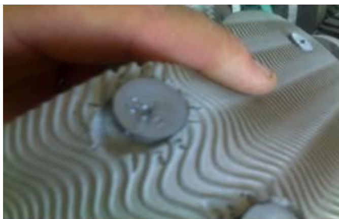
Figura 6: Devolução de clientes com fissuras visíveis a olho nu.
