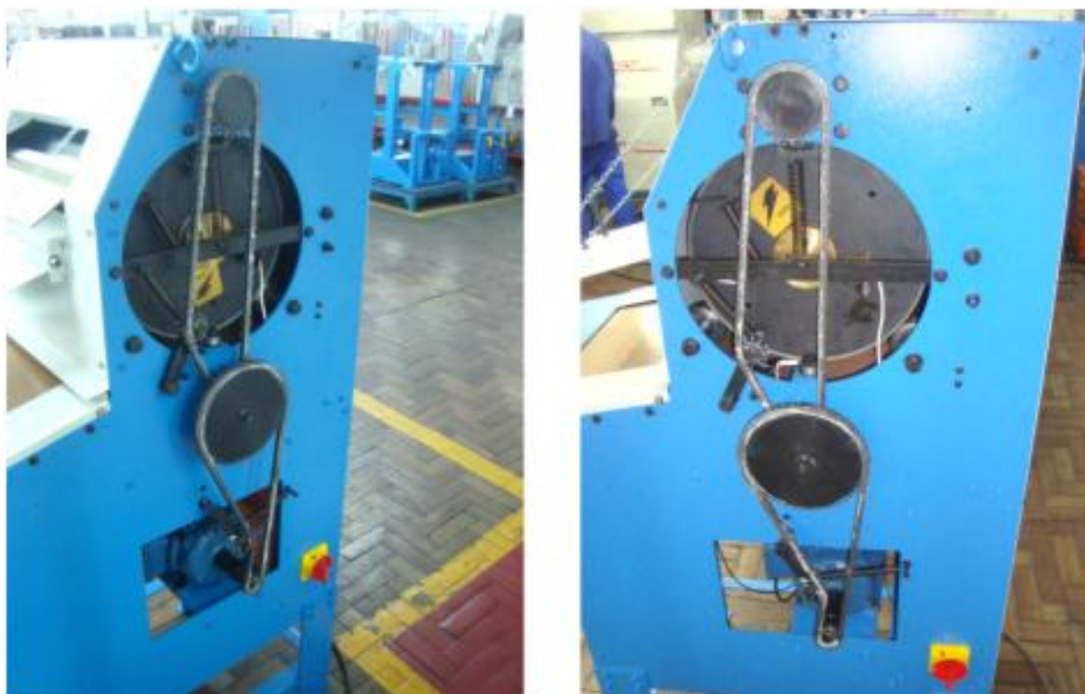
Figura 20 - Protótipo do novo sistema de transmissão de movimento da esteira transportadora da máquina para entretelar modelo WSK 404
