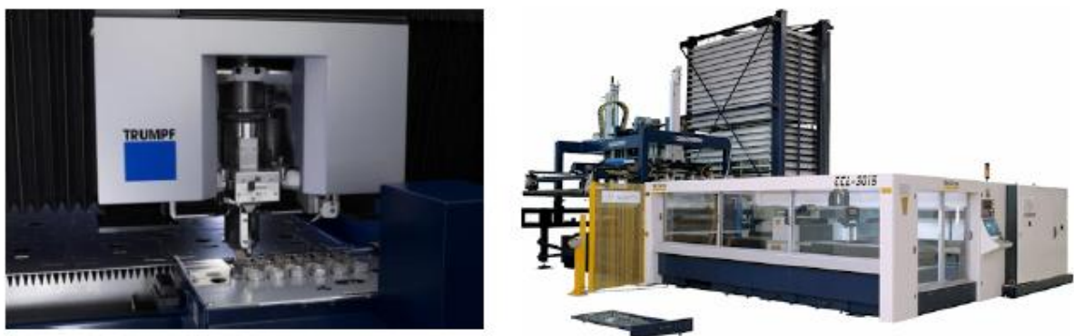
Figura 14 - Sistema de troca automática de nozzle e sistema de carga e descarga de chapa
