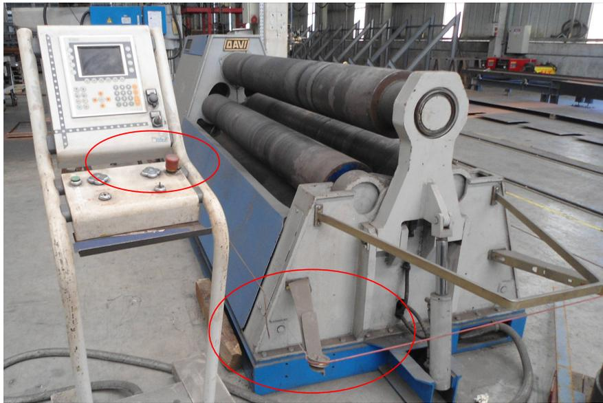
**Figura 22 – Painel com botão de emergência e cordão de emergência máquina calandra**
