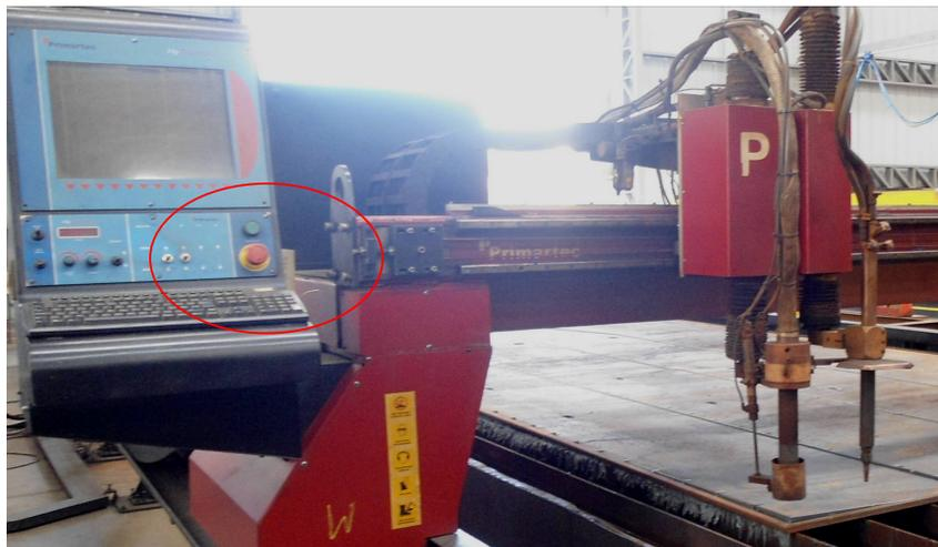
**Figura 21 – Painel com botão de emergência oxicorte CNC**
