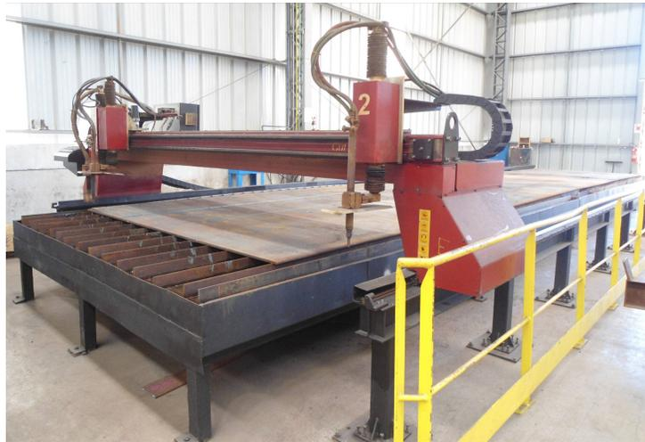
**Figura 15 – Máquina de oxicorte CNC**
