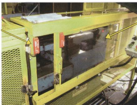
**Figura 5 – Enclausuramento de zona de prensagem por proteções móveis intertravadas - aberta**
