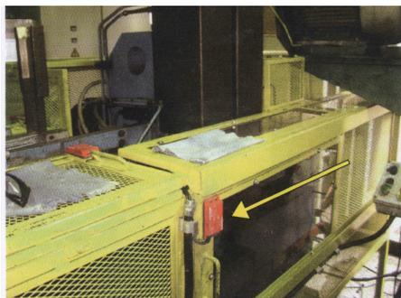
**Figura 4 – Enclausuramento de zona de prensagem por proteções móveis intertravadas - fechada**
