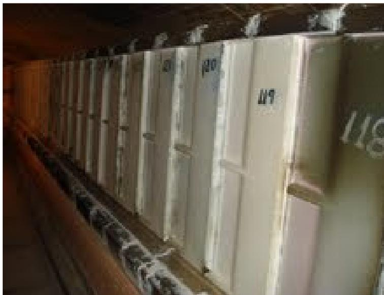
**Figura 11. Vista interna do forno, muflas que separam a zona de combustão e zona de queima.**
