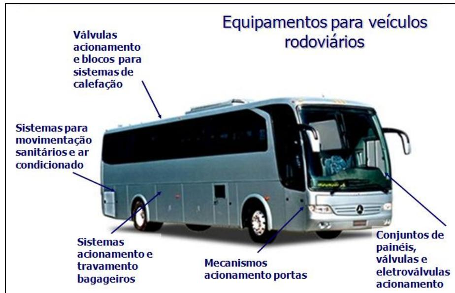
**Figura 18: Equipamentos fabricados**
