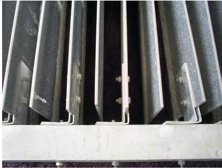
Figura 14 – Montagem alternada dos eletrodos empregados no tanque de eletrocoagulação.
