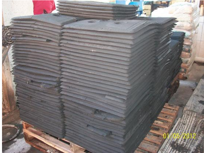
Figura 22 – “Tortas” de lodo já devidamente acondicionadas em estrado de madeira e prontas para descarte.
