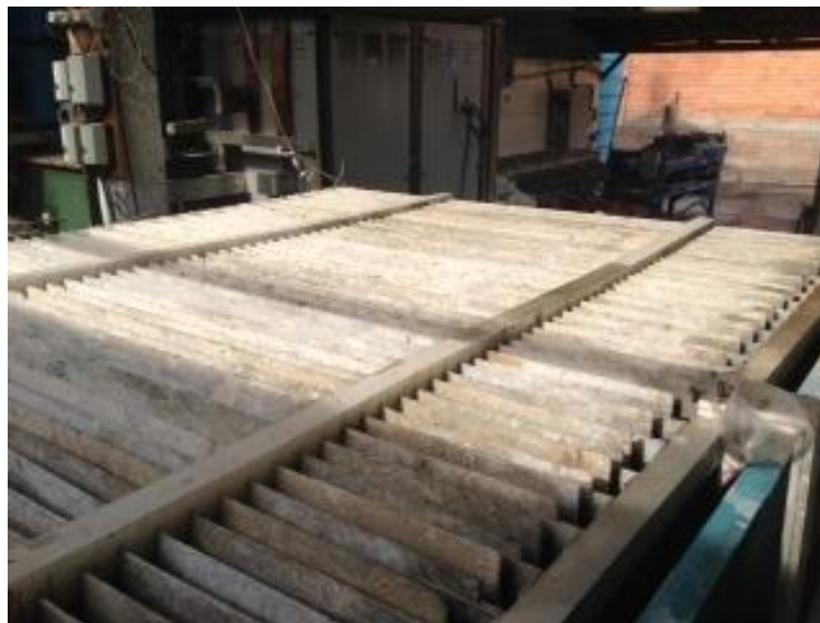
Figura 13 – Reator Eletroquímico contendo os eletrodos de alumínio.
