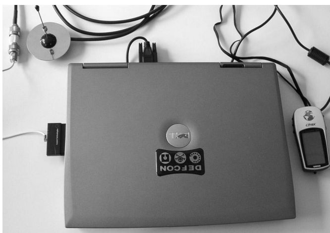
Figura 3.1 - Configuração típica para wardriving , utilizando laptop e GPS.
