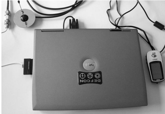
Figura 3.1 - Configuração típica para *wardriving*.
