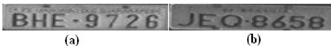
Figura 3.19 – Placa com Tipografia do mesmo caracter diferente. (a) Placa que contém o carecter “6” com características bem arredondadas; (b) Placa que contém o caracter “6” bem diferente da placa anterior dessa imagem
