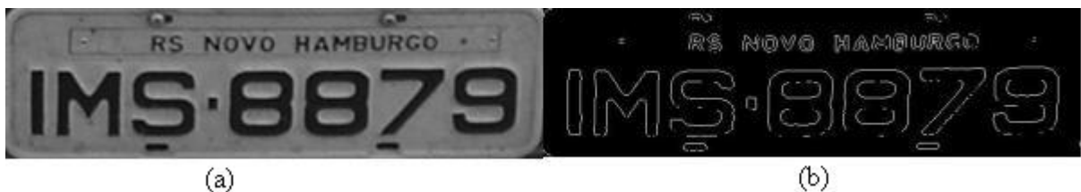
Figura 3.14 – (a) Placa do Veículo Enquadrada; (b) Placa do Veículo Enquadrada com Detector de Bordas Prewitt
