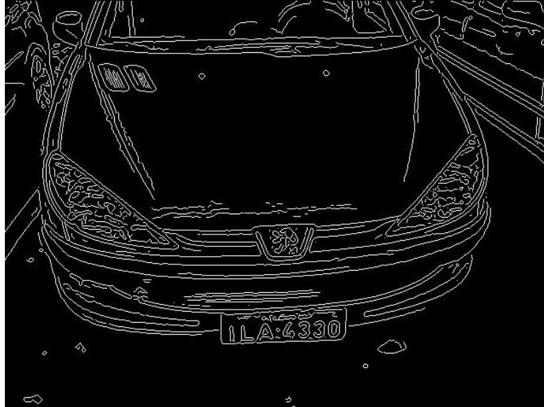
Figura 3.13 – Imagem de veículo que não foi possível encontrar a placa automaticamente.
