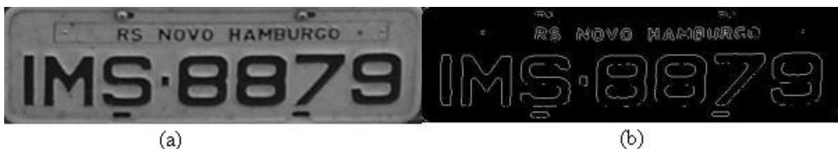
Figura 2.13 – (a) Placa do Veículo Enquadrada; (b) Placa com Detector de Bordas Prewitt.
