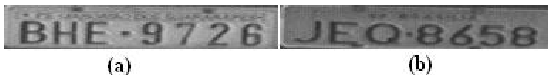
Figura 2.20 – Placa com Tipografia do mesmo caractere diferente. (a) Placa que contém o caractere “6” com características bem arredondadas; (b) Placa que contém o caractere “6” bem diferente da placa anterior dessa imagem.
