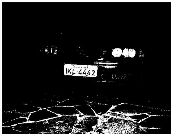
Figura 2.5 – Imagem aplicada a função *im2bw* com limiar 0.5.
