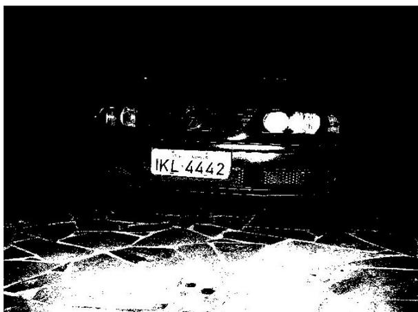
Figura 2.6 – Imagem aplicada a função *im2bw* com limiar 0.4.
