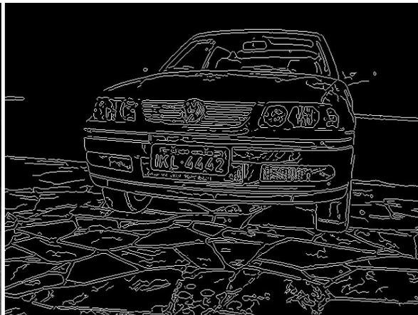
Figura 3.6 – Imagem aplicado operador de Canny.
