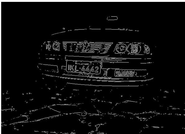
Figura 3.7 – Imagem aplicado operador de Sobel.
