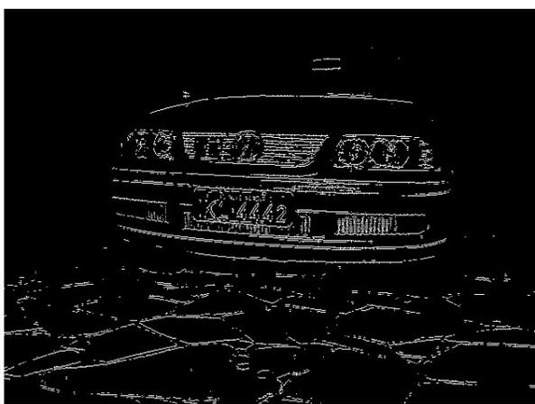
Figura 3.12 – Imagem aplicado à função edge na horizontal.
