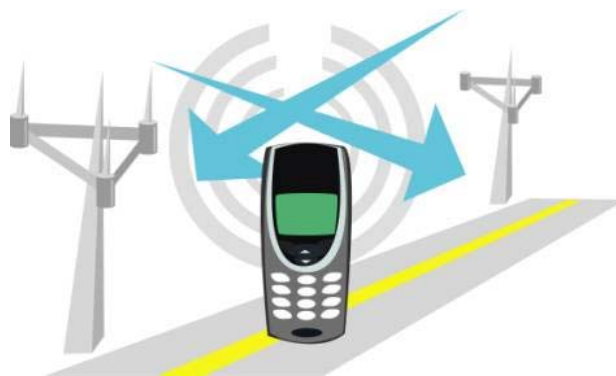
FIGURA 2.5 - Tecnologia Angle of Arrival . Fonte: ZURSTRASSEN, 2003.
