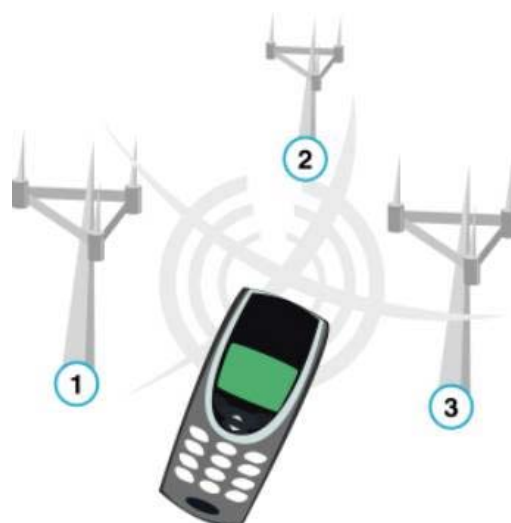
FIGURA 2.6 - Tecnologia Time Differential of Arrival . Fonte: ZURSTRASSEN, 2003.
