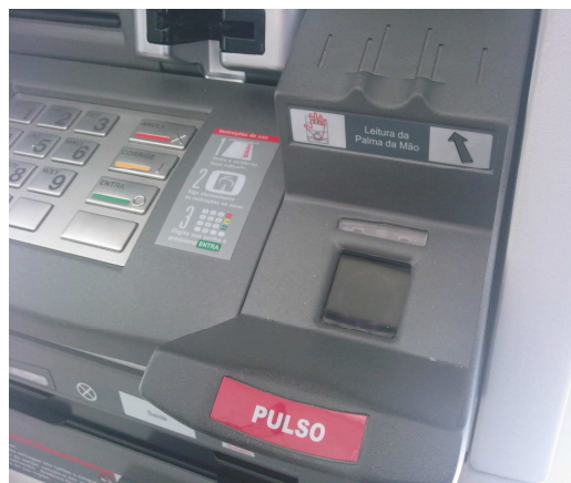
Figura 4.4: Imagem do leitor biométrico das veias da mão.
