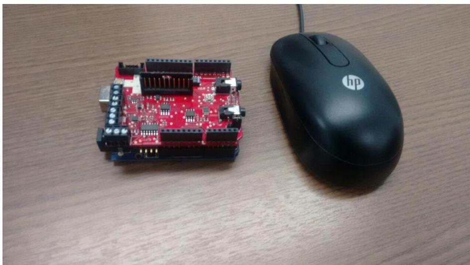
**Figura 16 – *e-Health* conectado ao Arduino em comparação ao tamanho de um mouse**
