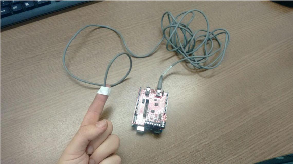
**Figura 21– Sensor de temperatura conectado a placa e ao dedo do usuário.**
