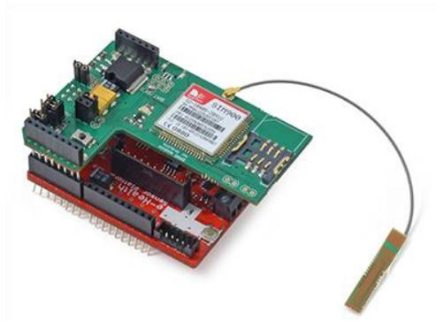
**Figura 13 – Shield e-Health Conectado ao módulo GPRS/SIM900**
