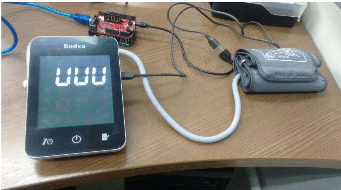
**Figura 24– Aparelho de pressão conectado a placa *e-Health***
