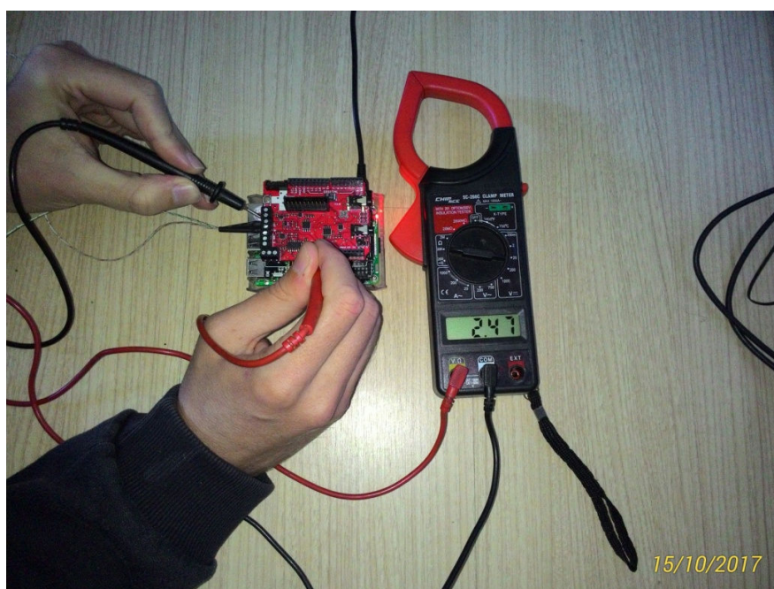
Figura 36 – Medição de Tensão do Shield e-Health
