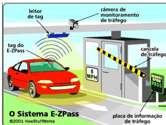
Figura 10 – Funcionamento do E-Z pass. Sistema de pedágio.
