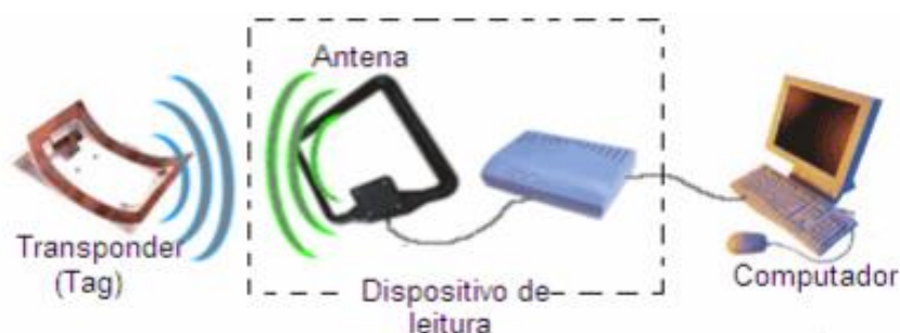
Figura 3 – Composição básica de um sistema RFID
