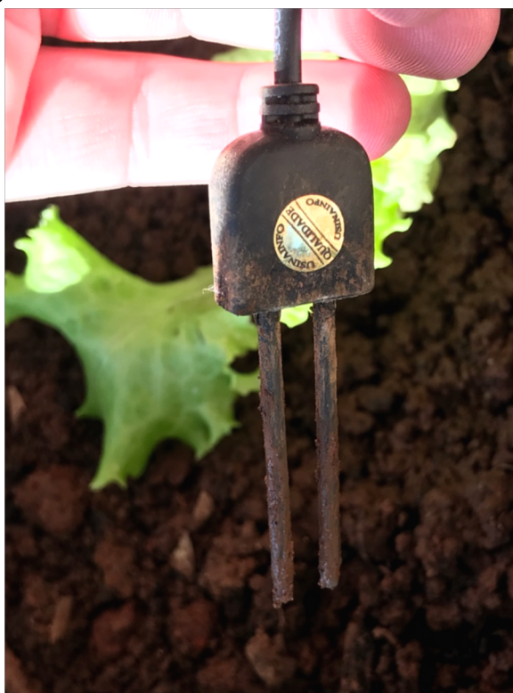
Figura 19 - Sensor de Umidade do Solo Arduino S12
