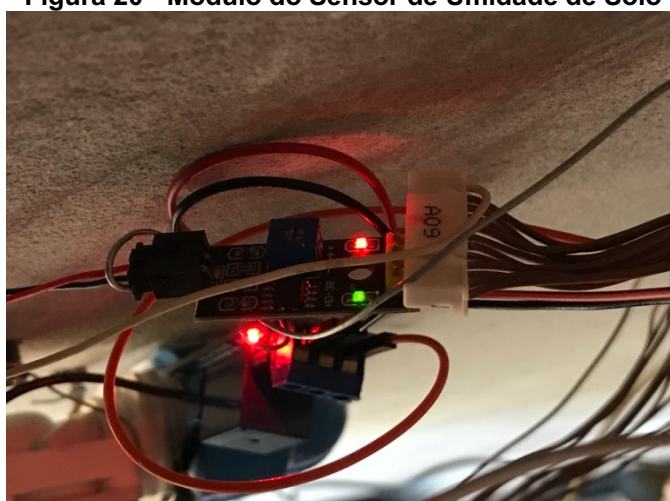
Figura 20 - Módulo do Sensor de Umidade de Solo
