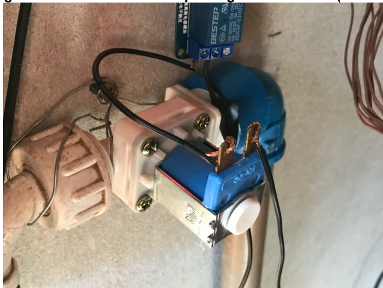
Figura 22 - Válvula Solenoide para Água 12V NF 180° (3/4 x 3/4)
