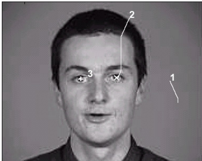
Figura 3-12 - Representação gráfica do processo de busca sacádica. Os números representam os pontos de início, enquanto o X aponta a detecção do olho esquerdo.
