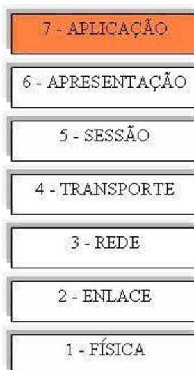
Figura 1.3 - Modelo OSI. Camada em que trabalha o *proxy*.
