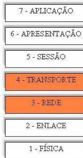
Figura 1.1 - Modelo OSI. Camada em que trabalha o filtro de pacotes.
