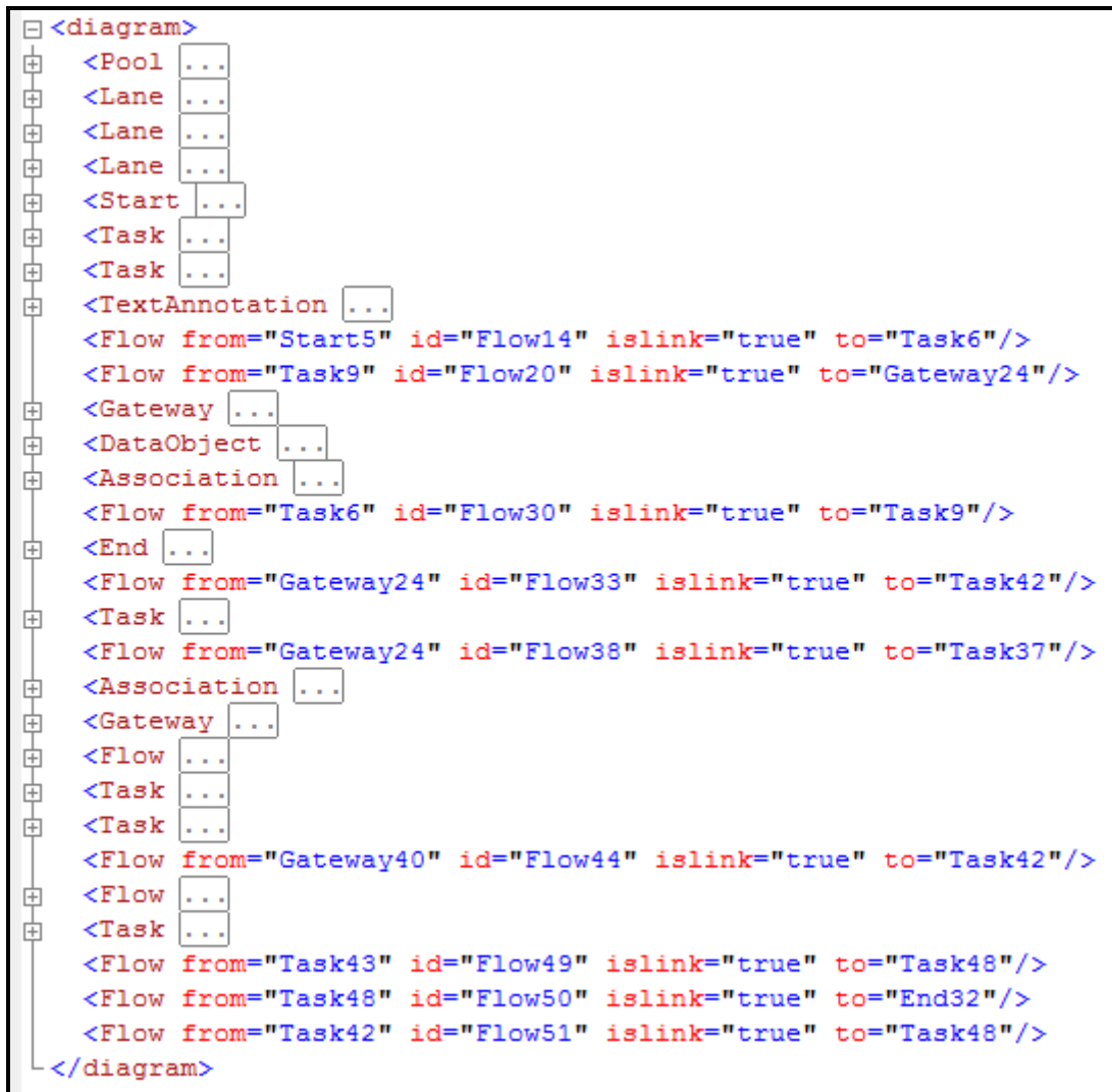
Figura 8.4 – Estrutura do arquivo XML do formato iLog.
