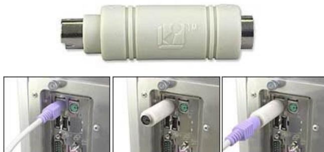
Figura 5.2 – Dispositivo *keylogger* instalado entre o conector do teclado e a respectiva porta localizada no computador.
