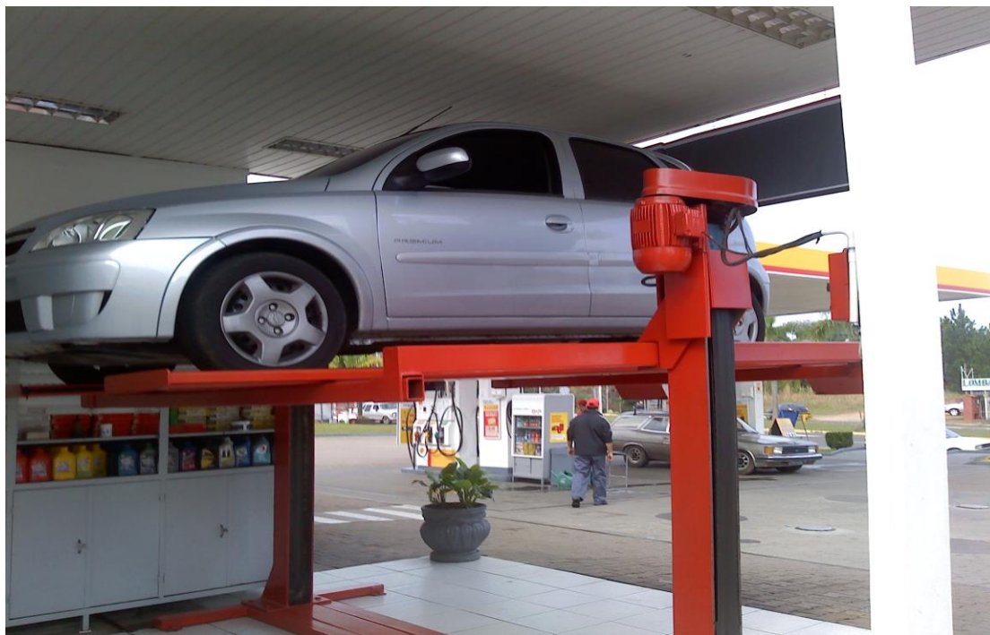
Figura 3.2 – Veículo colocado na rampa de troca de óleo
