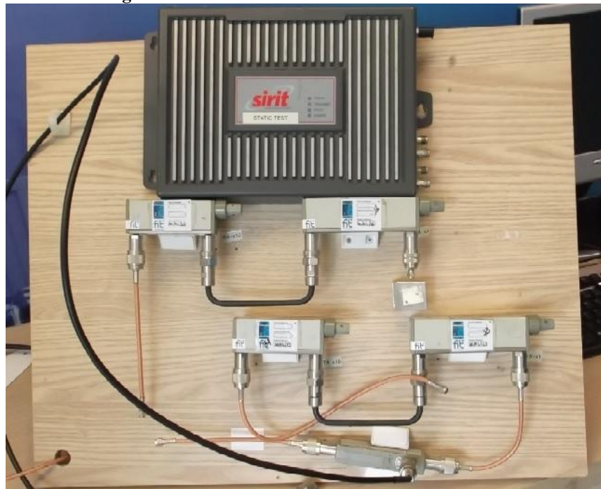
Figura 20: Modelo de leitor RFID 860 – 960 MHz.
