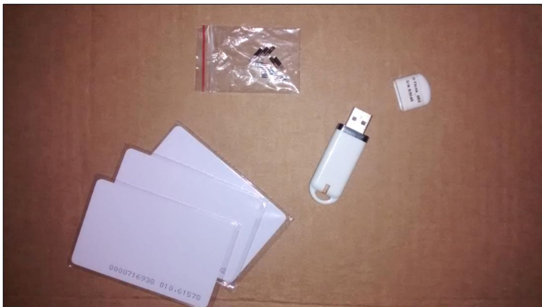
Figura 7.3: Leitor e tags RFID 125Khz (cartão e cápsula)
