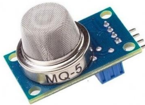
Figura 8 - Sensor de gás MQ-5
