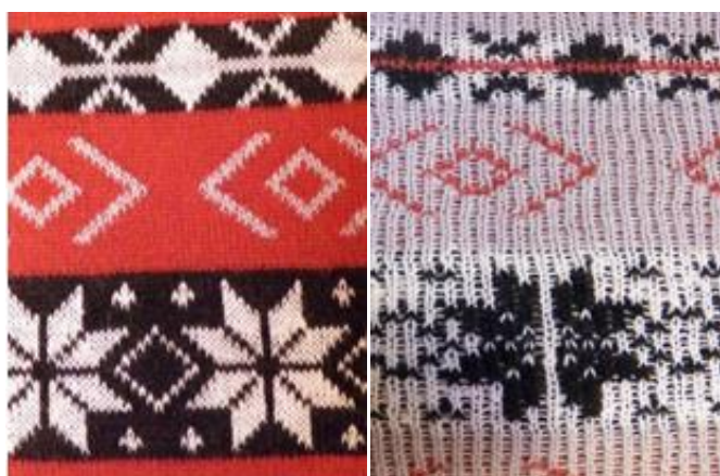
Figura 27 – Malha em Jacquard tecida em máquina dupla frontura vista do direito e do avesso Fonte: acervo da autora
