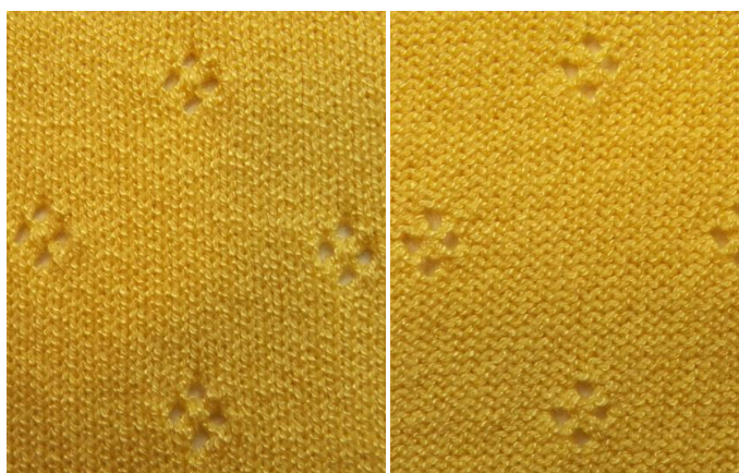
Figura 20 – Malha com vazados feitos através de transferência de pontos vista do direito e do avesso Fonte: acervo da autora
