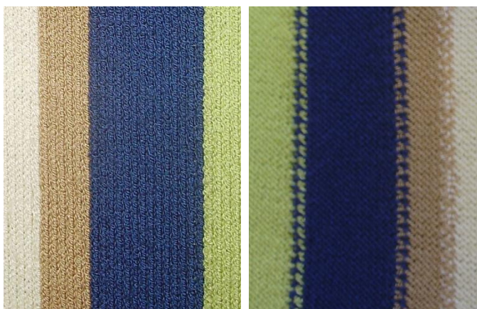
Figura 28 – Malha tecida com a técnica de intarsia vista do direito e do avesso Fonte: amostra cedida pela Paramalhas
