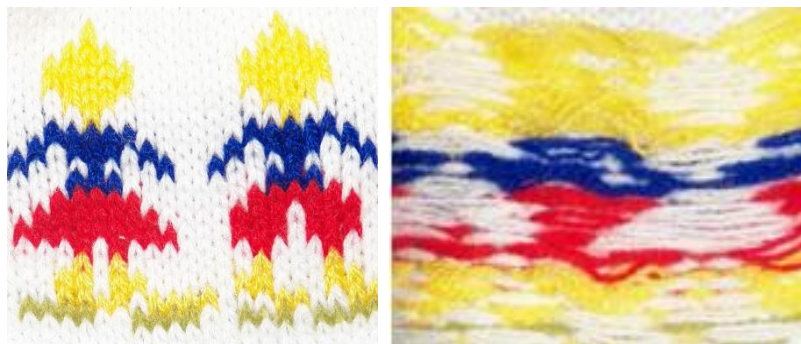
Figura 26 – Malha Jacquard tecida em máquina monofrentura vista do direito e do avesso Fonte: acervo da autora
