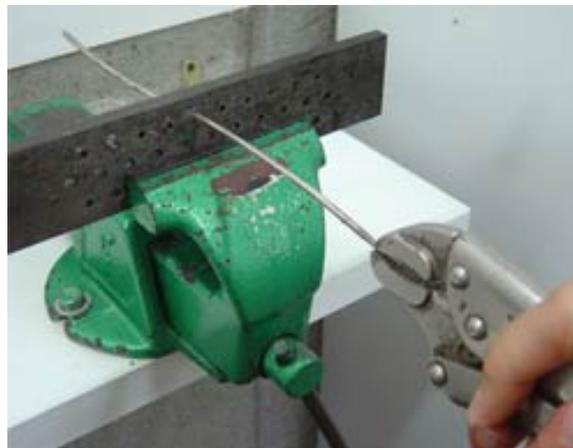
**Figura 50- Processo de trefilação: fio de metal sendo passado na fieira**
