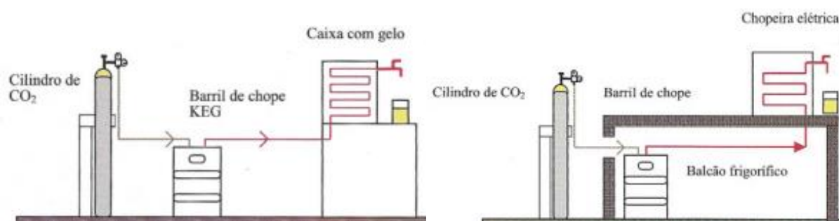
Figura 16 – Choqueira a gelo e choqueira elétrica
