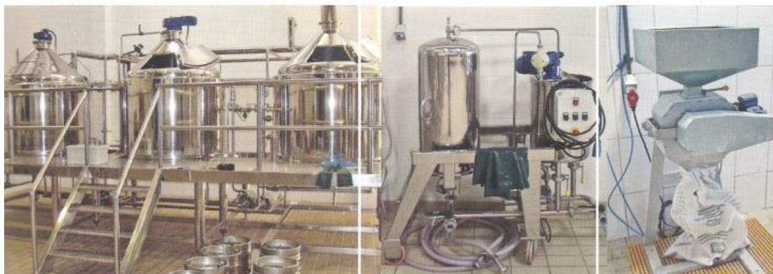
Figura 13 – Sala de cozimento, filtro de cerveja e moinho de malte
