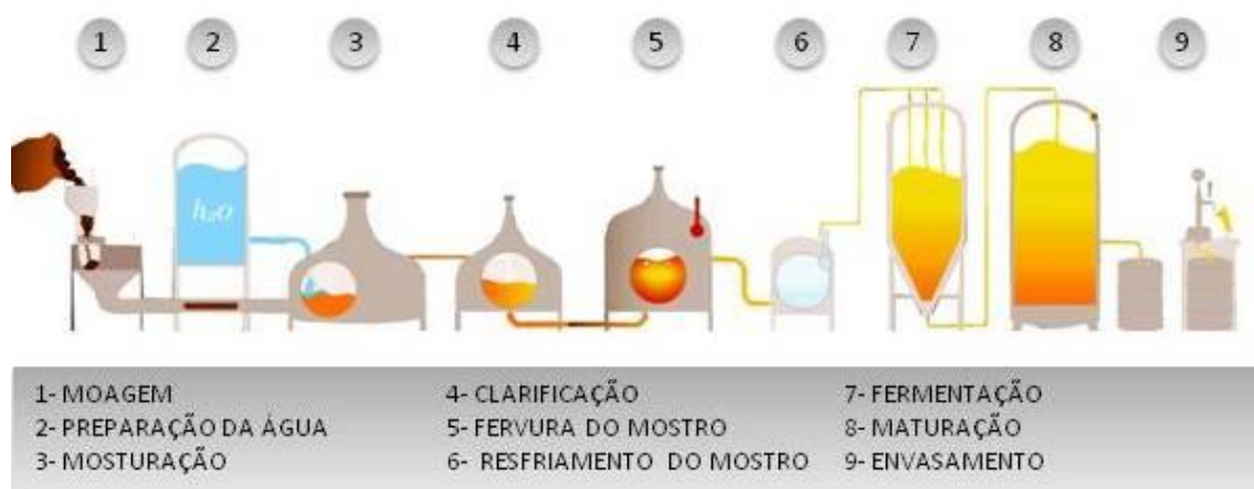
Figura 12 – Processos de fabricação da cerveja
