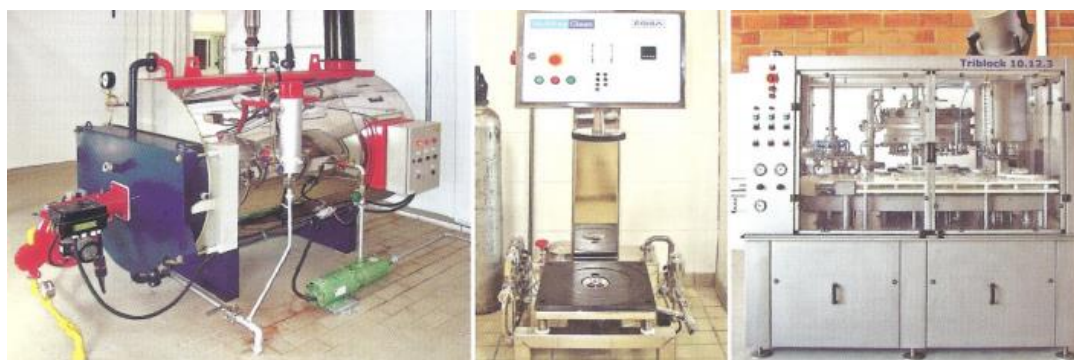
Figura 14 – Gerador de vapor, enchedora de barris e enchedora de garrafas
