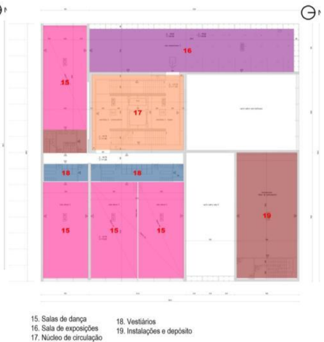
Figura 79 – Planta do terceiro pavimento.
