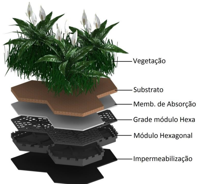
Figura 44 – Esquema da montagem do ecotelhado tipo Hexa
