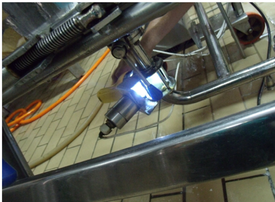
Figura 29 - Filtragem, pontos onde podemos visualizar a cerveja filtrada.
