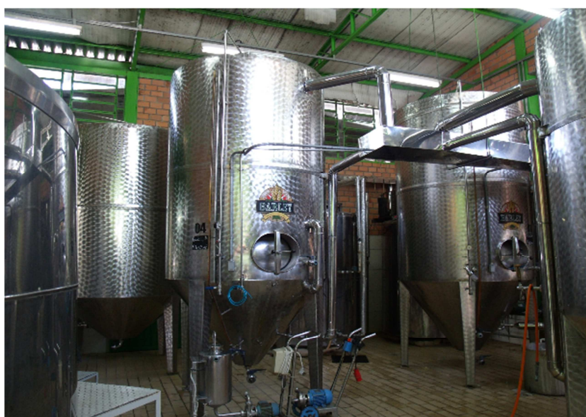
Figura 24 - Tanques de fermentação e resfriamento.
