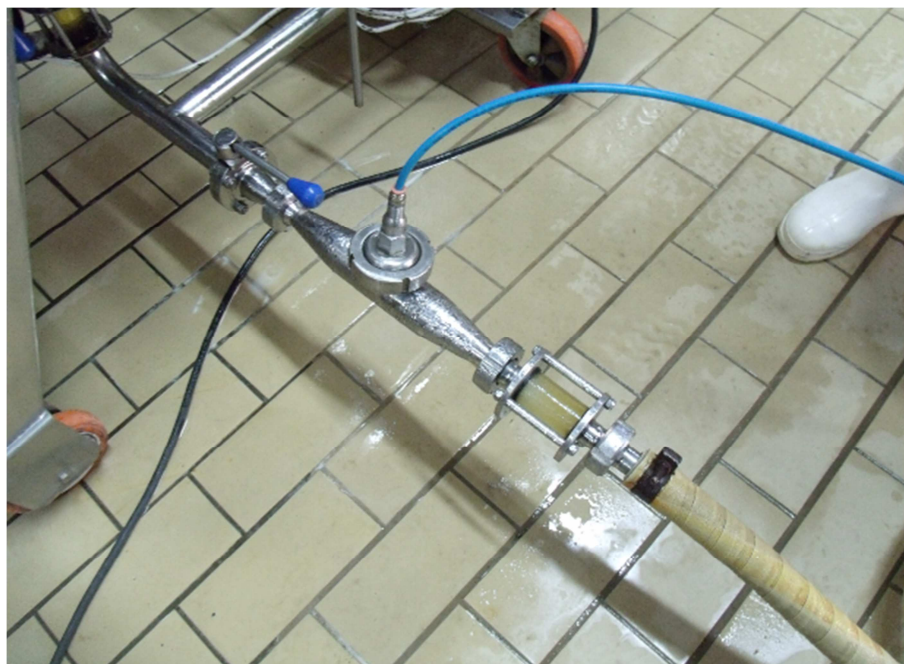
Figura 27 - Filtragem, pontos onde podemos visualizar a cerveja filtrada.
