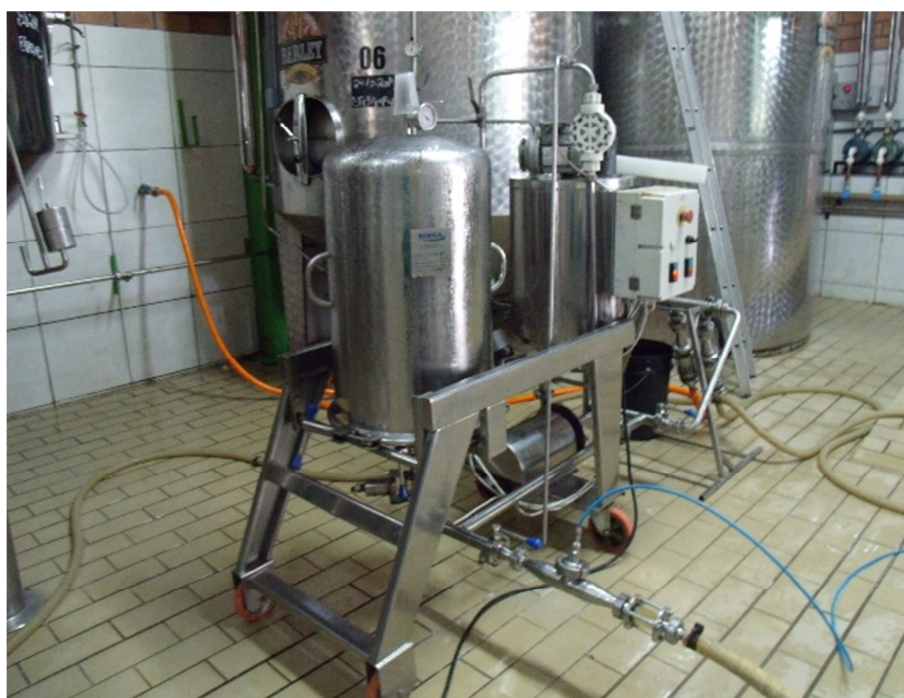
Figura 26 - Filtragem, transformação do líquido turvo em cristalino.
