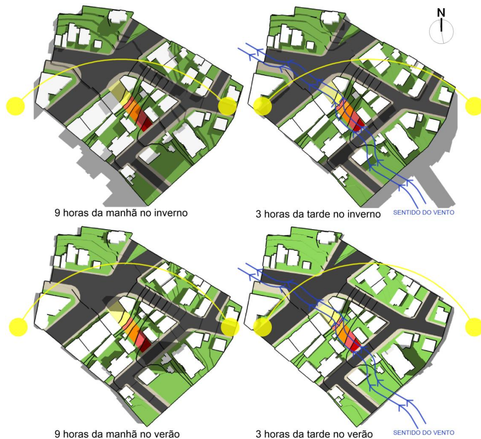
Figura 50 - Esquema de insolação e Ventilação
