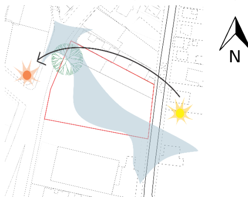
FIGURA 33 – PLANTA INSOLAÇÃO E VENTILAÇÃO
