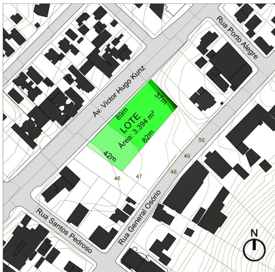
Figura 27 – Levantamento planialtimétrico do lote
